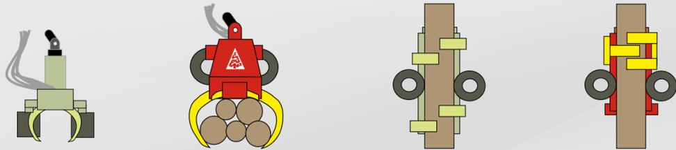
L'unité d'avancement repliable vers le haut de WOODY permet au grappin d'emporter plus de troncs en même temps. Avec WOODY, l'opérateur dispose d'un grappin de manutention parfaitement fonctionnel avec large ouverture et rotation sans fin.
