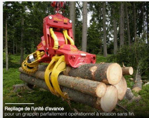
Repliage de l'unité d'avance pour un grappin parfaitement opérationnel à rotation sans fin.
